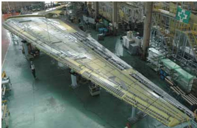
試験用負荷パッドを貼付けた静強度試験機用次期輸送機主翼
